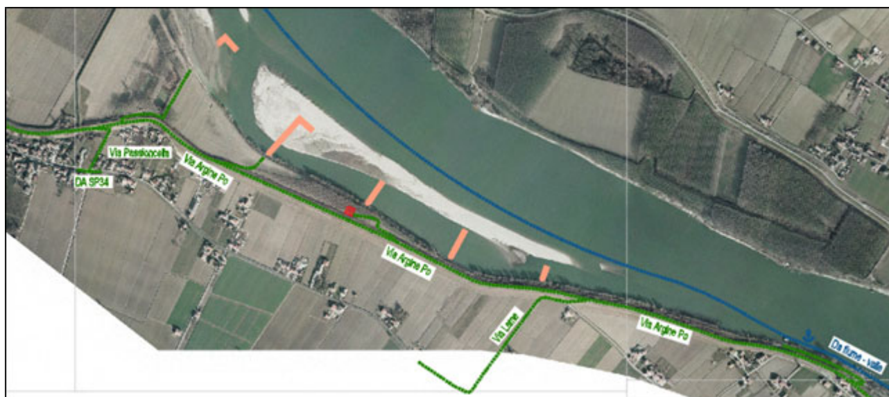
Figura 8 - Planimetria degli accessi all'area di cantiere INTERVENTO 3 in sponda destra (pennelli 1DX, 2DX, 3DX 4dx e 5DX)
